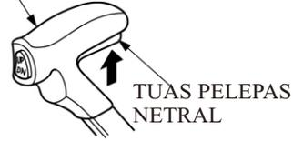
Tuas pelepas netral dipasang pada tuas remote kontrol guna mencegah operasi tak disengaja dari tuas remote kontrol.
